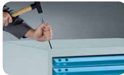
Punch out – Bei Bedarf können die Löcher herausgeschlagen und der Schubladenschrank nachträglich mit einer Tischplatte oder einem zweiten aufgesetzten Schubladenschrank ergänzt werden.
