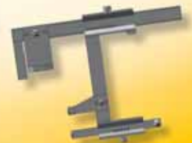
Sondermessschieber zur Vermessung von Eisenbahnrädern
