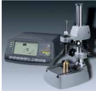
Einzelmessungen mit negativer Polarität (-A): Umkehren der Polarität bewirkt, eine kleinere Bohrung wird mit einem kleineren und einen größerer Durchmesser wird mit einem größeren Wert angezeigt
