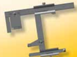
Sondermessschieber zur Vermessung von Eisenbahnrädern
