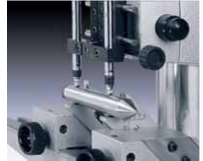
Differenzmessungen mit ungleicher Polarität (+A -B): Anwendung für Stufen-, Kegel- und Neigungsmessungen
